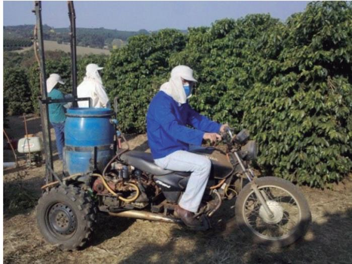
**FIGURA 2** - Triciclo adaptado para pulverização na cafeicultura de montanha
